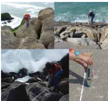
Figura 2. Exemplo de ensaios esclerométricos efectuados nos geomateriais do manto resistente da estrutura.
