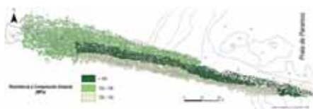
Figura 8. Cartografia dos geomateriais constituintes do manto resistente do esporão de Paramos, em termos de resistência com base nos ensaios esclerométricos de campo.
