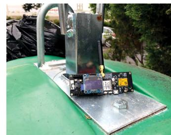
Sonda utilizada para efetuar a medição do nível de sinal nas diferentes situações.
