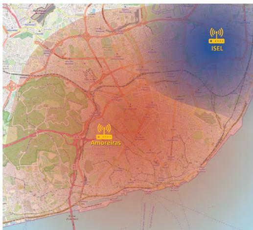
De salientar que o equipamento instalado no ISEL está a funcionar em modo de diversidade, com duas antenas, de forma a aumentar a probabilidade de êxito na receção de mensagens.
