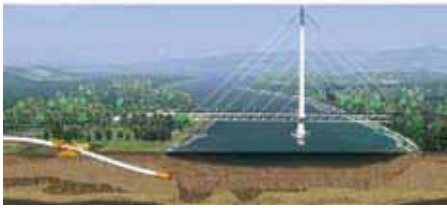
Fig. 251 – Utilização do Direct Pipe
