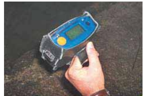
Figura nº 11 Monitorização da qualidade do ar, com controlo de gases (metano, sulfídrico, monóxido de carbono e oxigénio). A monitorização regular da qualidade do ar, em conjugação com o sistema de ventilação, permitiu a execução dos trabalhos em condições de segurança. Os valores resultantes das leituras, situaram-se sempre dentro dos intervalos de segurança.
