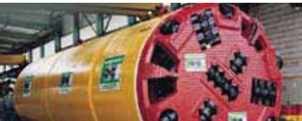
Fig. 10 – Equipamento de perfuração de microtúneis com escudo simples
