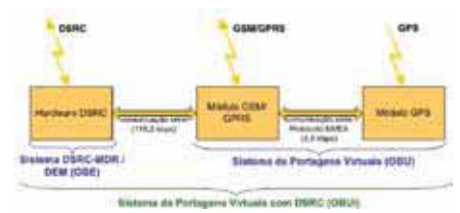
Fig. 3 – Diagrama de blocos do OBU.
