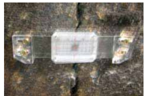
Figura nº 13 Fissurómetros para controlo da estabilidade, em fendas e fissuras. Detecta movimentos da estrutura, através da leitura directa nas réguas. As réguas são posicionadas no valor zero e são fixas, nos bordos da fenda ou da fissura.
